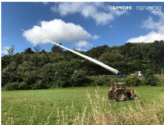
Transporte especial de palas de aerogeneradores mediante bladelifter
