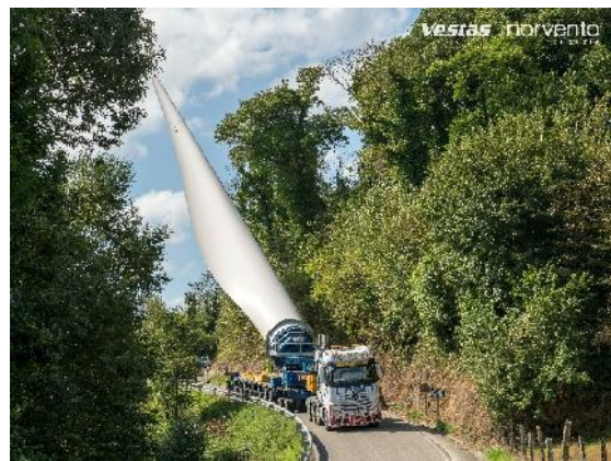
Transporte especial de palas de aerogeneradores mediante bladelifter
