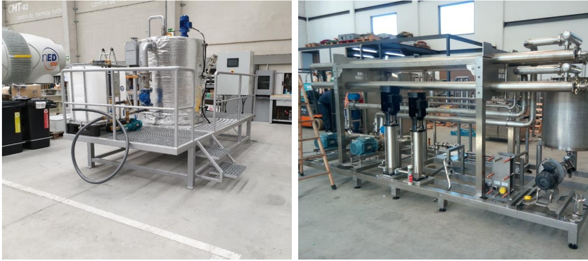
Foto 1: Digestor UASB y máquina de nanofiltración y ósmosis inversa de la planta integral VARAL.
