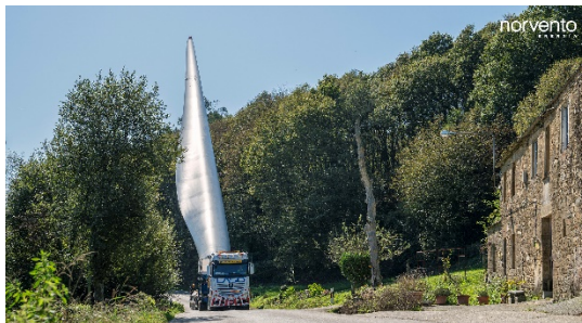
Transporte de palas mediante bladelifter
