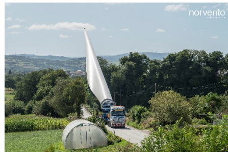
Transporte de palas mediante bladelifter
